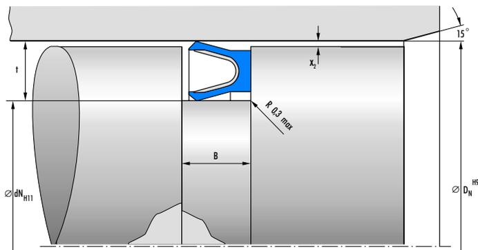
**7. Монтажные размеры силового уплотнения FOA из PTFE**
